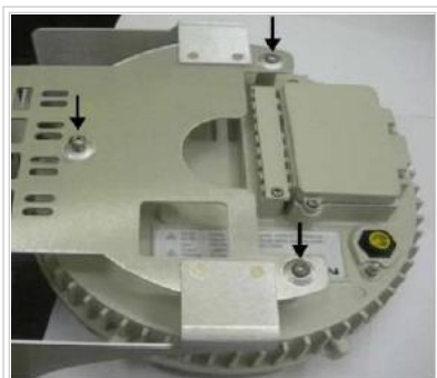
Fig. 2 - Separación del equipo de su base
