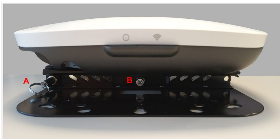
Fig. 8 - Bloqueo de AP en soporte
