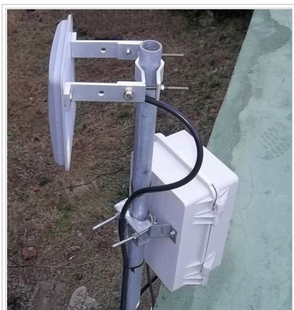
Fig. 1 - Mikrotik fijado a caño
