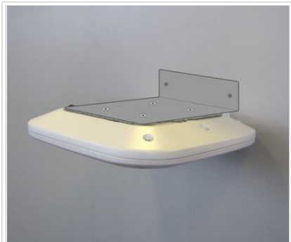
Fig. 8 - AP fijado a pared
