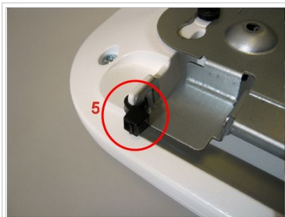
Fig. 5 - Asegurando el AP a la platina
