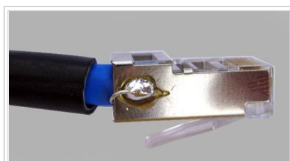
Fig. 4 Terminación de ficha blindada - FTP
