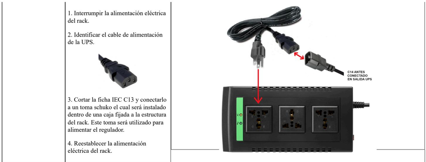
Si fuera necesario retirar el regulador y no se cuenta con un regulador de repuesto se deberá agregar un cable de alimentación estándar (schuko a IEC C13), para suministrar energía desde el toma schuko que alimentaba el regulador a la ficha IEC C14 que estaba conectada a su salida.
