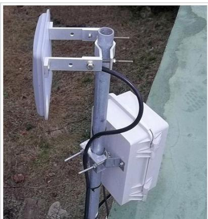
Fig. 1 - Mikrotik fijado a caño
