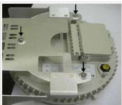
Fig. 2 - Separación del equipo de su base
