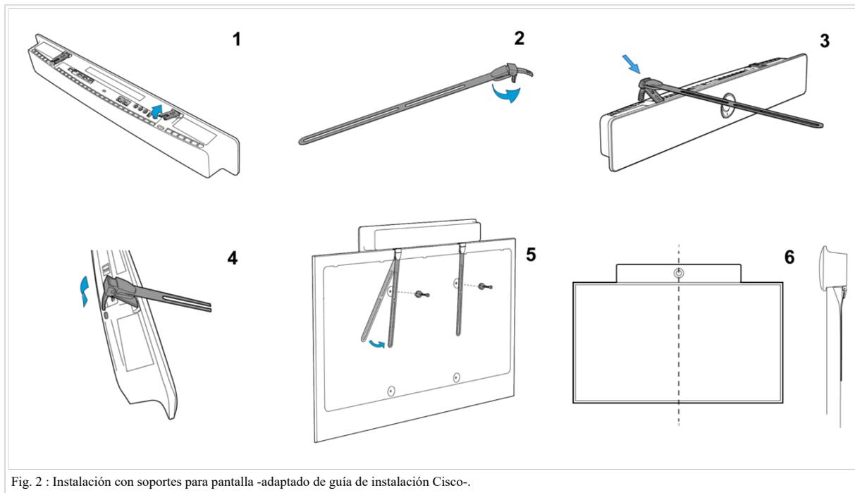
Fig. 2 : Instalación con soportes para pantalla -adaptado de guía de instalación Cisco-.
