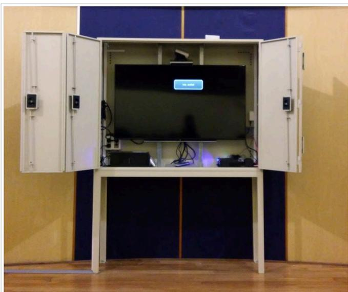
Fig. 9 : Soporte con cuatro puntos de fijación al piso.
