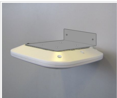
Fig. 8 - AP fijado a pared
