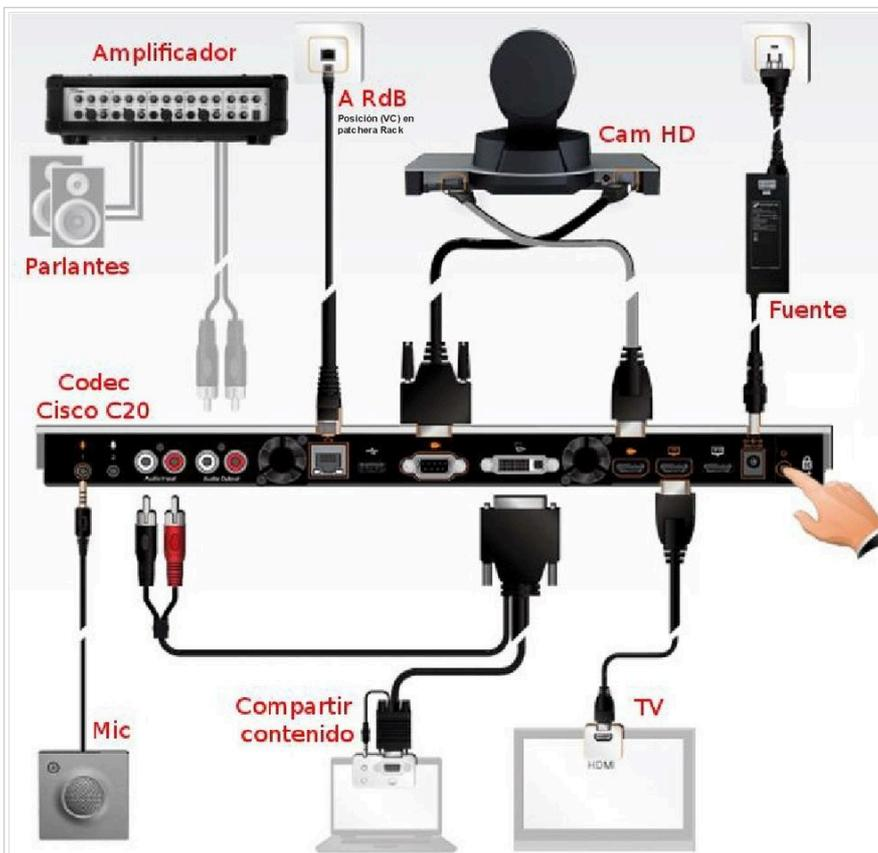
Fig. 21 : Interconexión de equipos con Codec Cisco C20.
