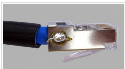
Fig. 4 Terminación de ficha blindada - FTP
