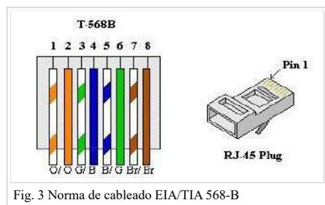
Fig. 3 Norma de cableado EIA/TIA 568-B
