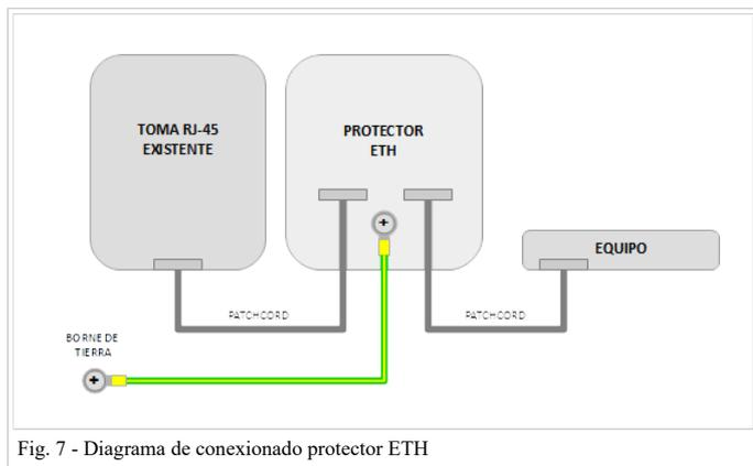
Fig. 7 - Diagrama de conexionado protector ETH
