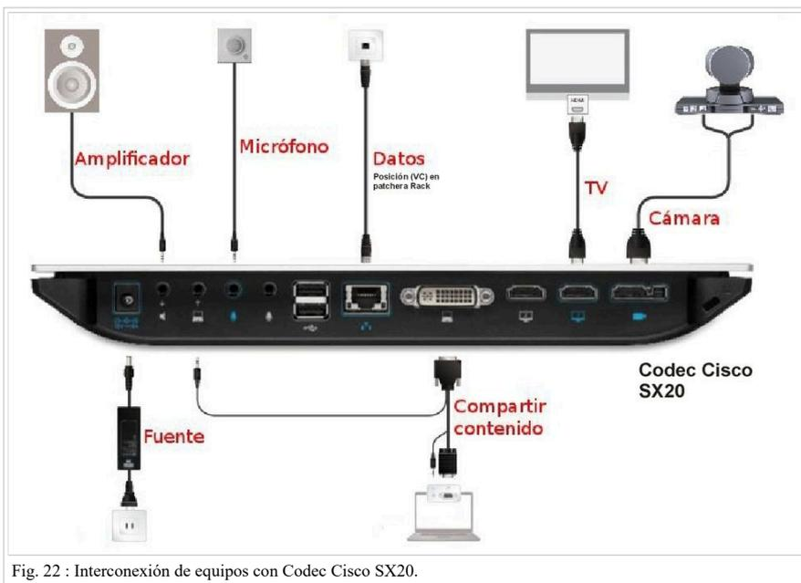
Fig. 22 : Interconexión de equipos con Codec Cisco SX20.
