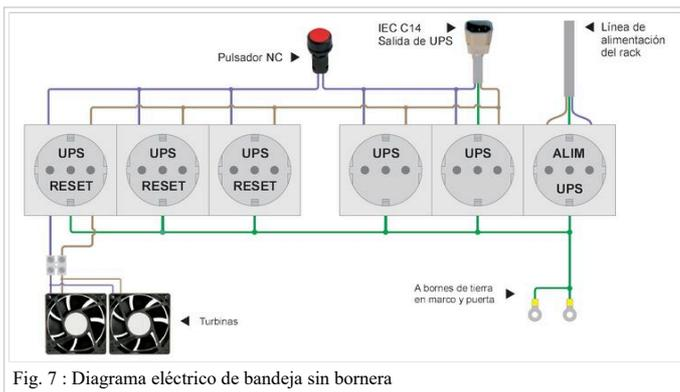
Fig. 7 : Diagrama eléctrico de bandeja sin bornera
