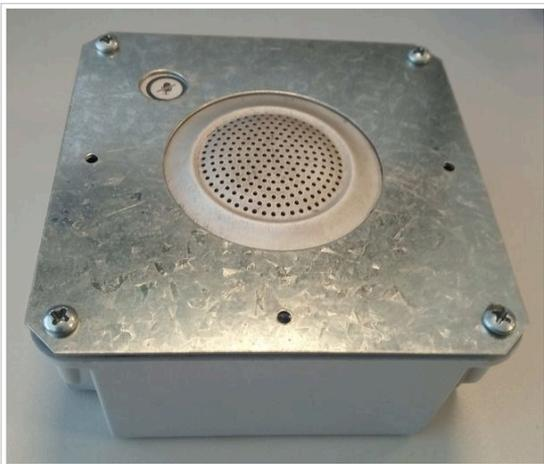
Fig. 19 : Micrófono en caja con tapa de chapa.
