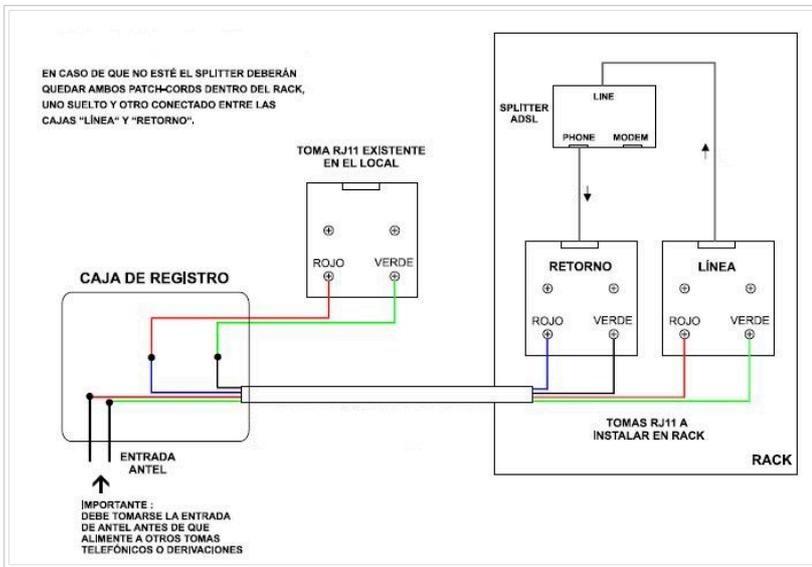
Fig. 2 - Diagrama de instalación telefónica (no vigente)
