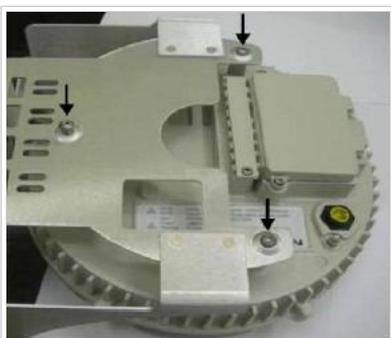
Fig. 2 - Separación del equipo de su base
