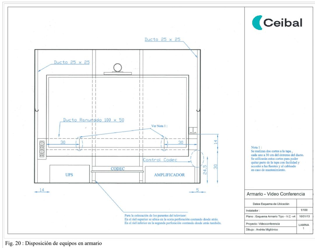
Fig. 20 : Disposición de equipos en armario
