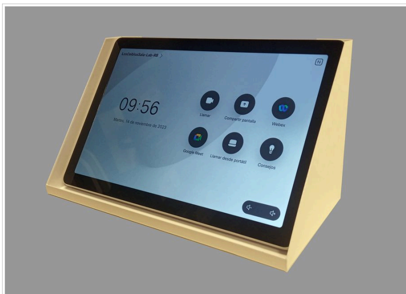
Fig. 2 : Panel táctil en soporte para pared
