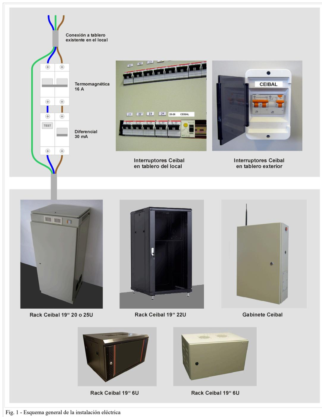
Fig. 1 - Esquema general de la instalación eléctrica
