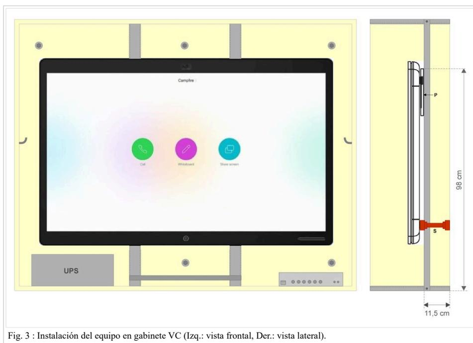
Fig. 3 : Instalación del equipo en gabinete VC (Izq.: vista frontal, Der.: vista lateral).
