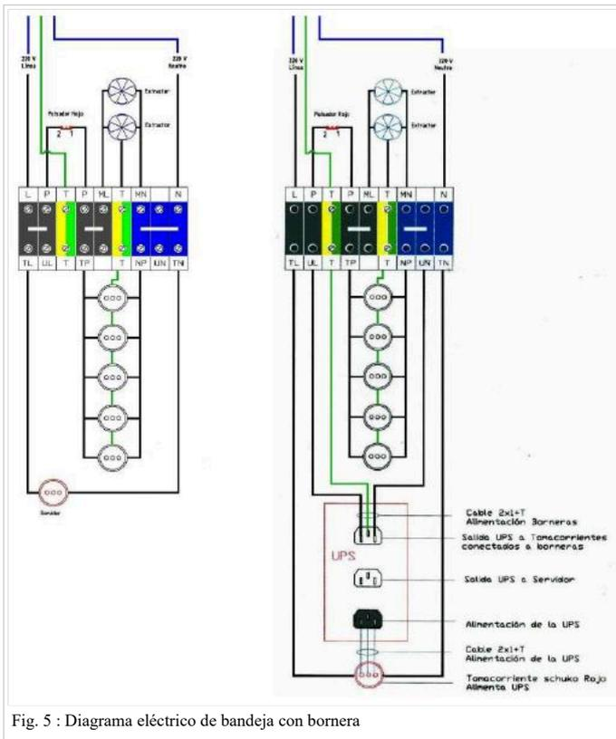
Fig. 5 : Diagrama eléctrico de bandeja con bornera
