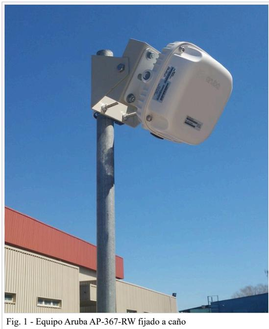
Fig. 1 - Equipo Aruba AP-367-RW fijado a caño
