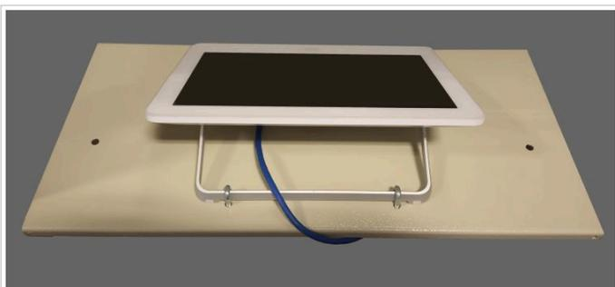
Fig. 4 : Fijación de panel táctil al estante
