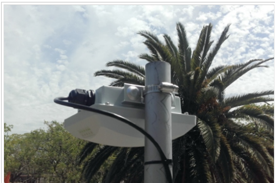
Fig. 1 - Equipo Ruckus T300 fijado a caño
