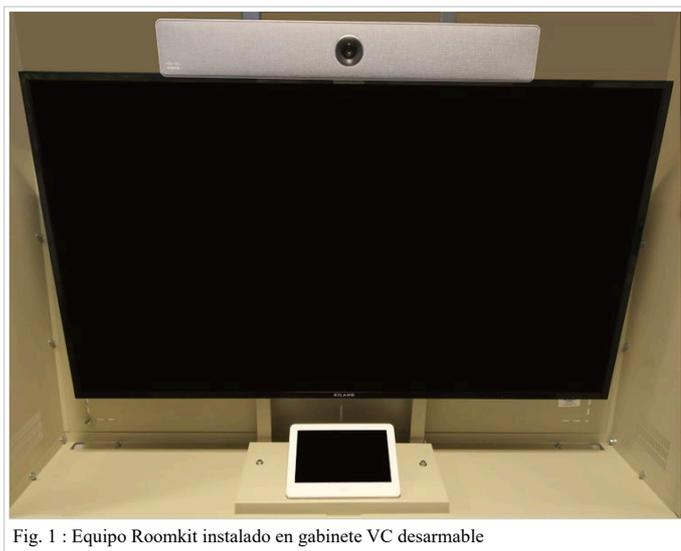
Fig. 1 : Equipo Roomkit instalado en gabinete VC desarmable
