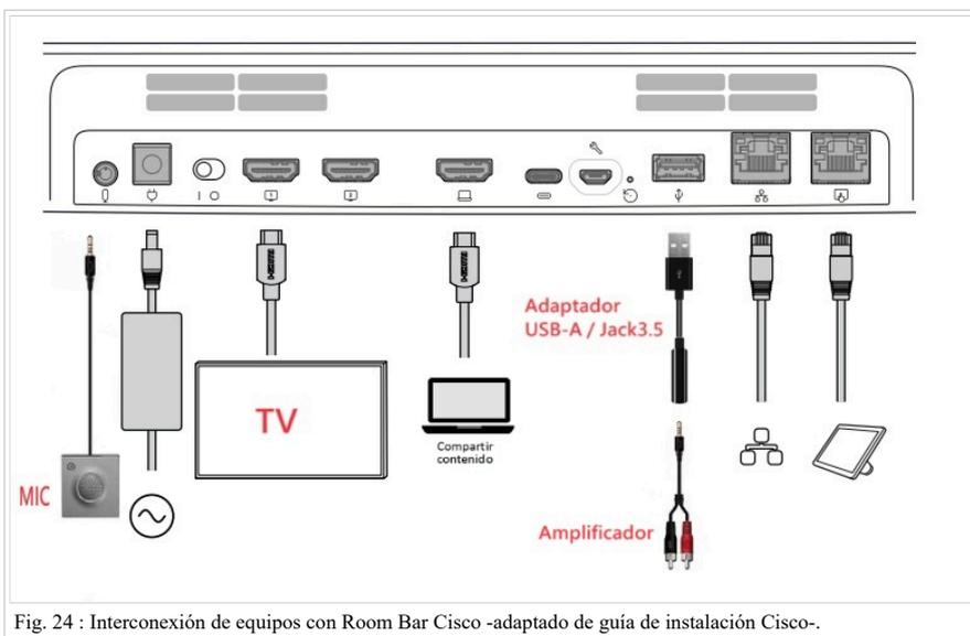
Fig. 24 : Interconexión de equipos con Room Bar Cisco -adaptado de guía de instalación Cisco-.
