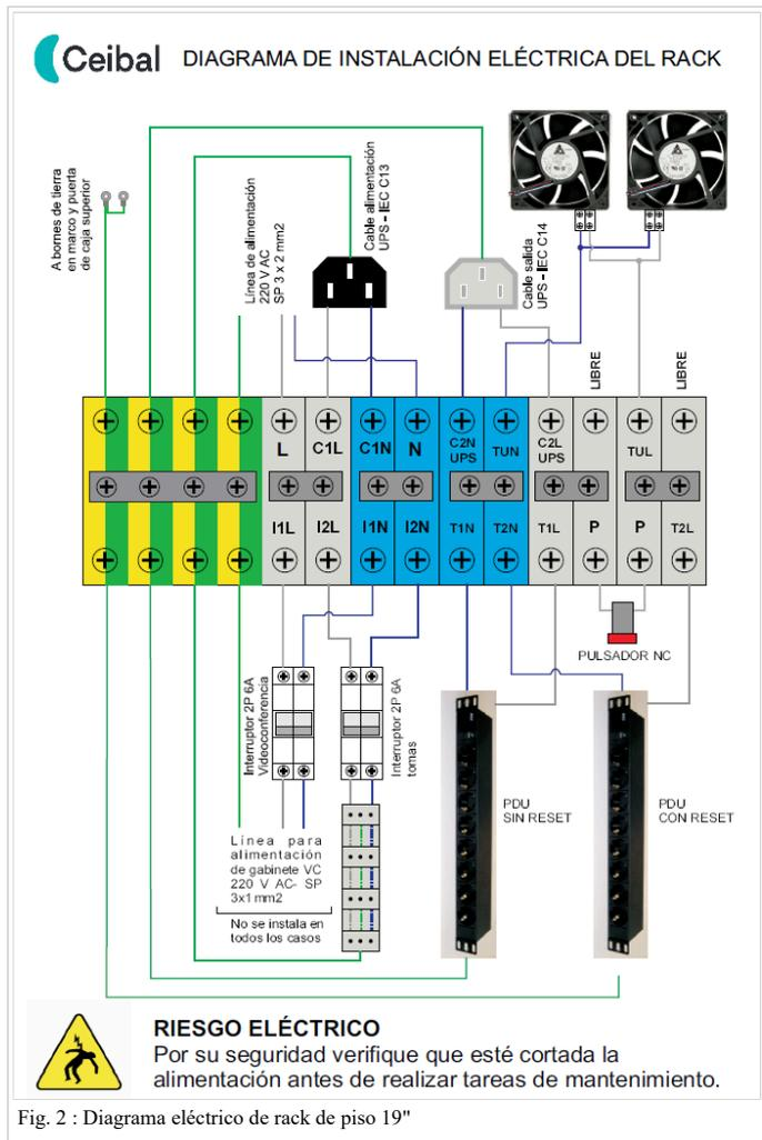
Fig. 2 : Diagrama eléctrico de rack de piso 19"
