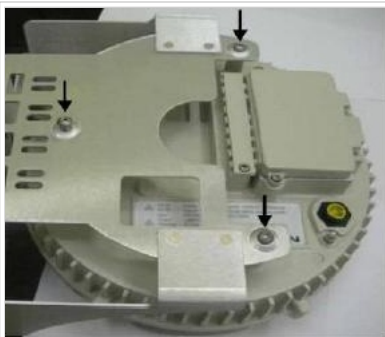
Fig. 2 - Separación del equipo de su base
