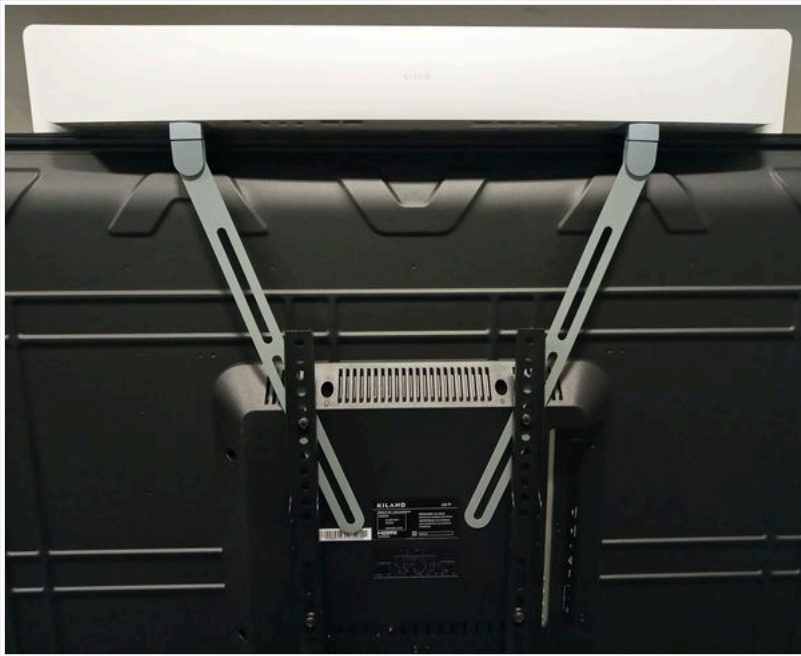
Fig. 3 : Roomkit instalado en TV VESA 200 x 200 mm
