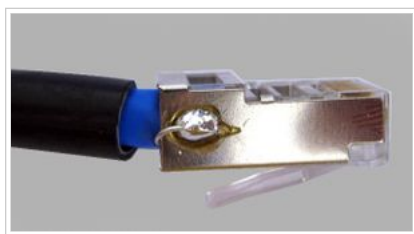
Fig. 4 Terminación de ficha blindada - FTP
