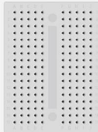
Permite interconectar componentes utilizando cables con pines macho.
