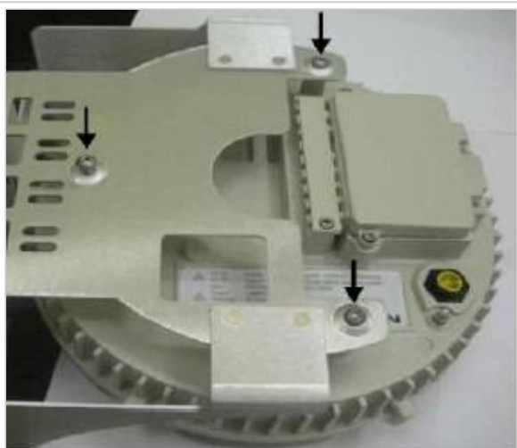
Fig. 2 - Separación del equipo de su base
