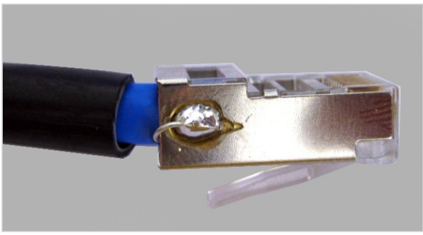
Fig. 2 Terminación de ficha blindada - FTP
