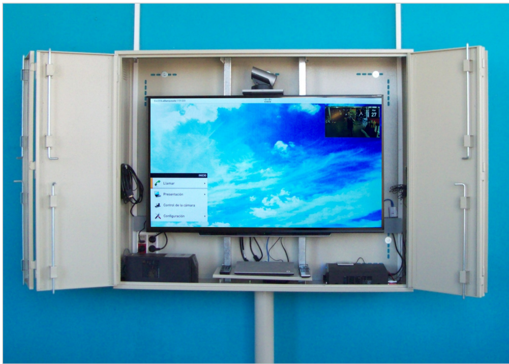
Fig. 1 : Armario con equipos de Videoconferencia.
