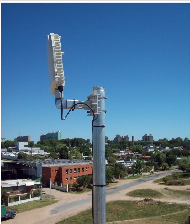
Fig. 5 - Wavion direccional
