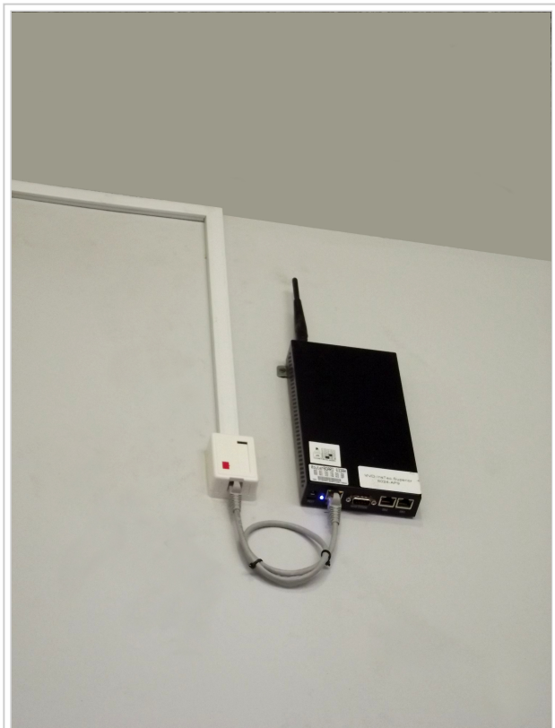
Fig. 1 - AP Mikrotik interior
