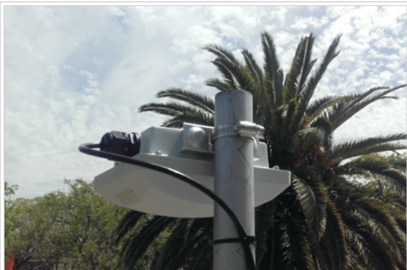
Fig. 1 - Equipo Ruckus T300 fijado a caño
