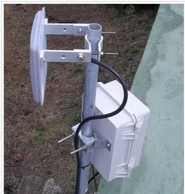
Fig. 1 - Mikrotik fijado a caño
