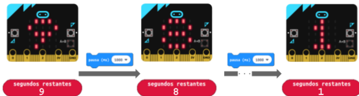
La disminución de la variable y la espera del bloque pausa durante la ejecución de la cuenta regresiva.
