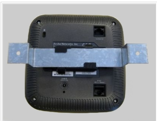
Fig. 6 - AP Aruba fijado a soporte metálico tipo omega
