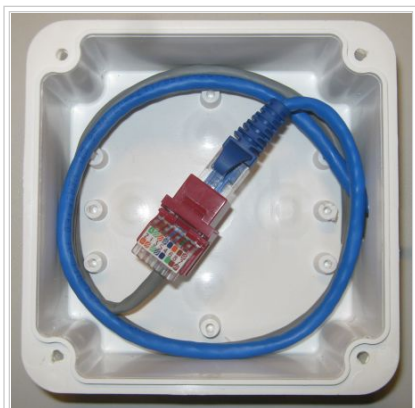
Fig. 1 Jack en caja de registro exterior
