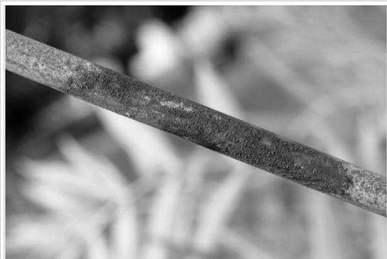
Fig. 13 - Corrosión superficial en rienda por contacto Cobre-Galvanizado
