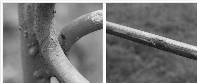
Fig. 1 - Desprendimiento del galvanizado
