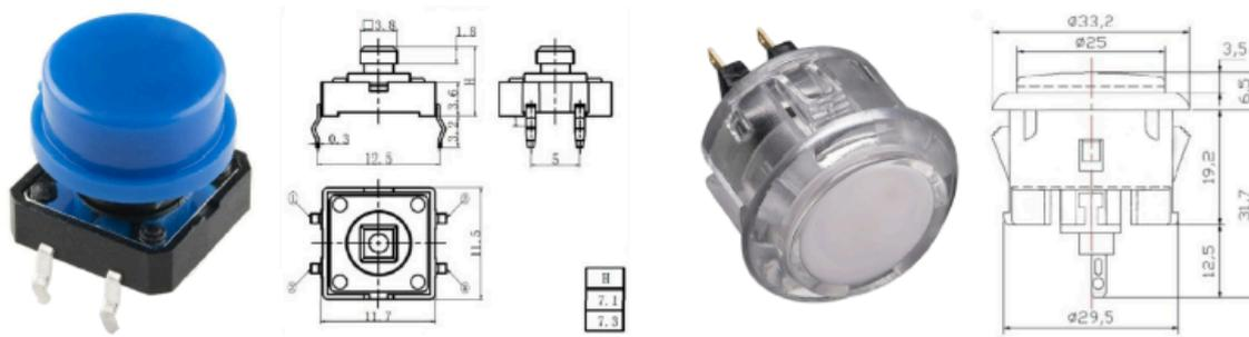
Figura 20: a) Botón para el cambio de modos (izquierda). b) Botón para extensión de los botones A y B (derecha). Todas las medidas están en mm.
